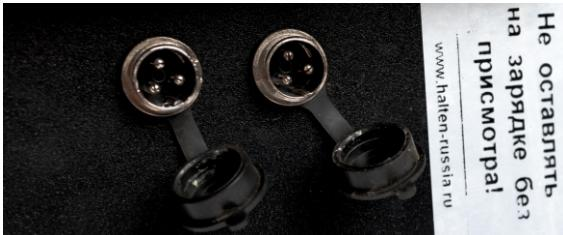
3. Откройте заглушку разъема для зарядки (см. рисунок), подключите к разъему зарядное устройство, включите зарядное устройство в сеть.
