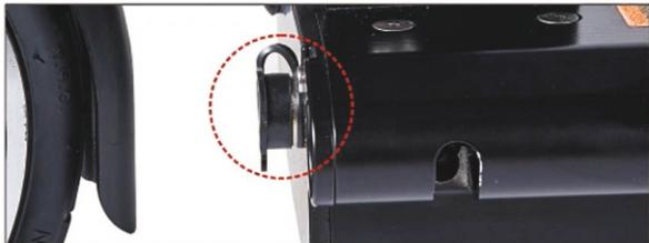
3. Откройте заглушку разъема для зарядки (см. рисунок), подключите к разъему зарядное устройство, включите зарядное устройство в сеть.
