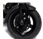
Убедитесь, что болты, гайки и крепежные элементы тормозной системы не ослаблены, а тормозной диск не деформирован и не поврежден.
