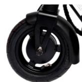
Пониженное давление может привести к неравномерному износу шин, а также создает потенциальную опасность во время резкого торможения. Эксплуатация электросамоката с изношенными или поврежденными шинами не допускается. Замену или ремонт изношенных или поврежденных шин следует выполнять своевременно.
