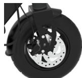
Убедитесь, что болты, гайки и крепежные элементы тормозной системы не ослаблены, а тормозной диск не деформирован и не поврежден.
